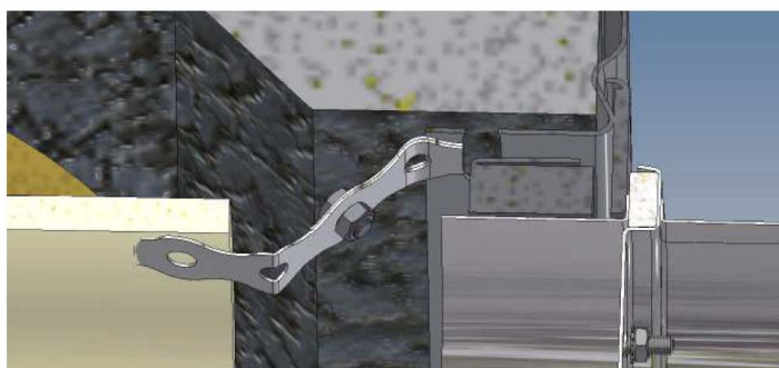
Abb. 20: Einbaubeispiel bei kurzem Türrahmen
