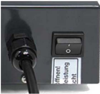
Abb. 23: Ausschalten der Steuerung
