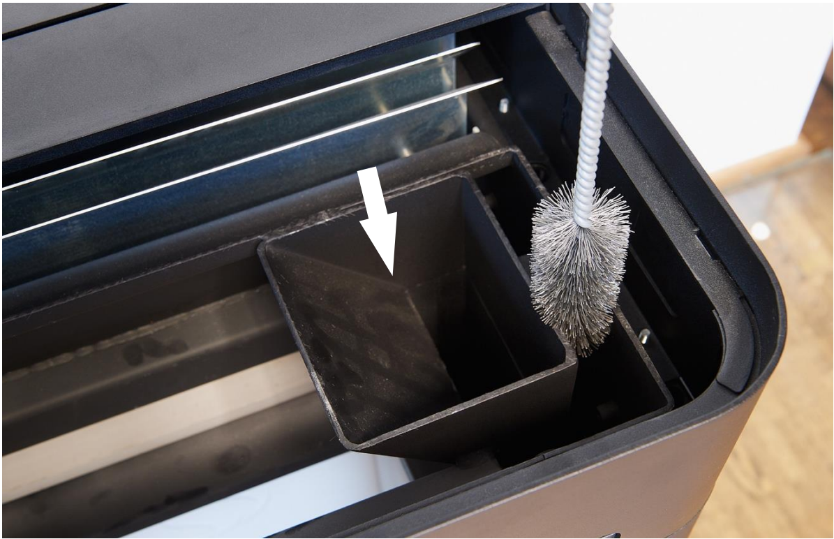
Rauchgaszüge von oben, diese sind zu reinigen
