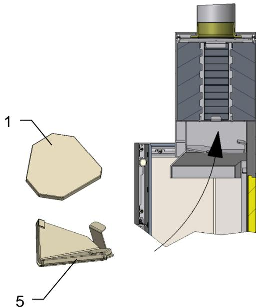
Zum Reinigen der Ofenrohre und dem Speicherblock die beiden Umlenkplatten (1) und (5) ausbauen.
