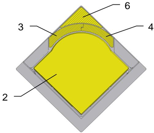
Nach dem Einbau der Bodenplatte (2), der linken Seitensteine (3) und der rechten Seitensteine (4) diese zueinander mittig ausrichten.
