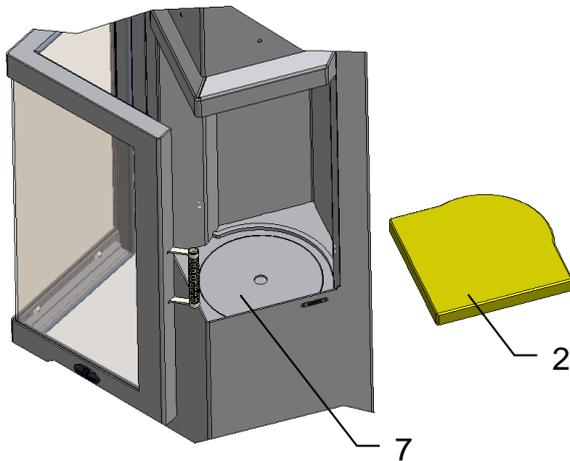
Feuerraumboden (2) gemäß Bild einsetzen und nach vorne schieben.
