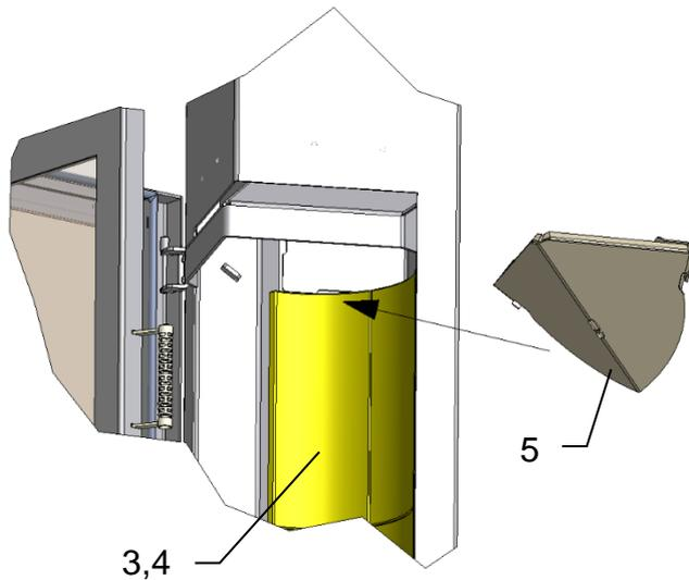
Die Umlenkplatte (5) wie abgebildet in den Feuerraum einführen, vorne auf den seitlichen Auflagen und hinten auf den Seitensteinen (3,4) aufliegen.
