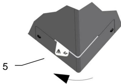
Den Brennstoffwählhebel (5) an der Rückseite des Kaminofens auf die Stellung „Scheitholz“ stellen bis der Hebel einrastet.
