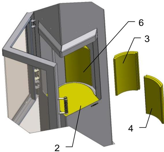
Den linken Seitenstein (3) und den rechten Seitenstein (4) wie abgebildet zwischen Bodenplatte (2) und Eckstein (6) einsetzen.
