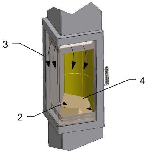
Die für den Abbrand benötigte Verbrennungsluft wird über den Luftschieber (1) geregelt. Mit dem Luftschieber (1) wird die Primärluft (2) und die Sekundärluft (3) mit einem Hebel (1) geregelt.
