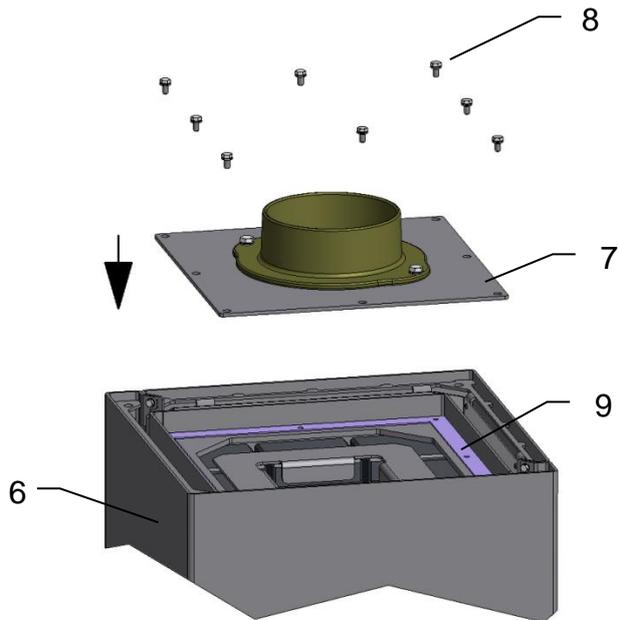
Den Speicherkasten (6) mit dem Speicherdeckel (7) wieder dicht verschließen.
