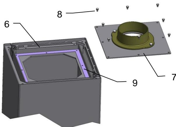
Zum Einbau der Speichersteine (5) den Speicherdeckel (7) durch Lösen der 8 Sechskantschrauben (8) vom Speicherkasten (6) abnehmen. Darauf achten, daß die Dichtung (9) nicht beschädigt wird.
