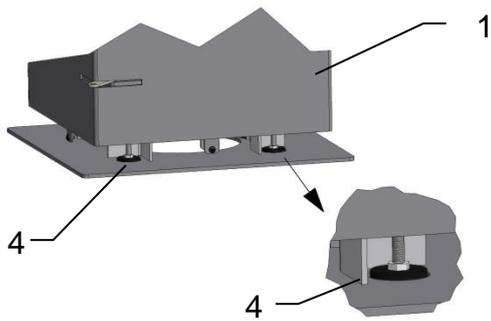
Kaminofen (1) an den Aufstellungsort bringen und mit Wasserwaage auf waagrechte Position prüfen.
