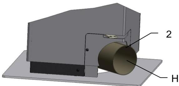
Je nach Ausführung des Kaminofens müssen vorbereitete Ausbrüche vorgenommen werden, oder spezielle Bauteile montiert werden.
