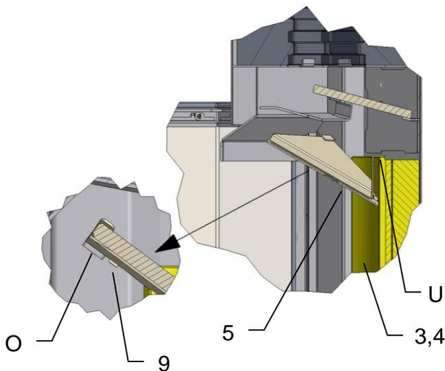
Die Umlenkplatte (5) muss wie abgebildet auf der oberen Ablage (O) und hinten mit der Lasche (U) auf den Seitensteinen (3,4) aufliegen.
