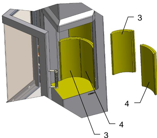
Den nächsten linken Seitenstein (3) auf den bereits eingebauten Seitenstein (3) einsetzen.
