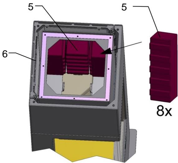
Die Speichersteine (5) wie dargestellt mit den Rippen nach innen in den Speicherkasten (6) einsetzen.
