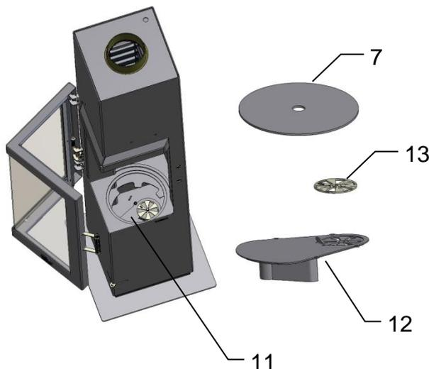
Zum Reinigen der **Brennkammer** (11) die Brennumraumauskleidung komplett ausbauen. Den Bodendeckel (7) entnehmen. Den Revisionsdeckel (12) und die Luftscheibe (13) demontieren. Luftkanäle mit einem geeigneten Staubsauger säubern. Beim anschließenden Zusammenbau darauf achten, dass die Kennzeichnung auf der Luftscheibe (13) sichtbar oben ist
