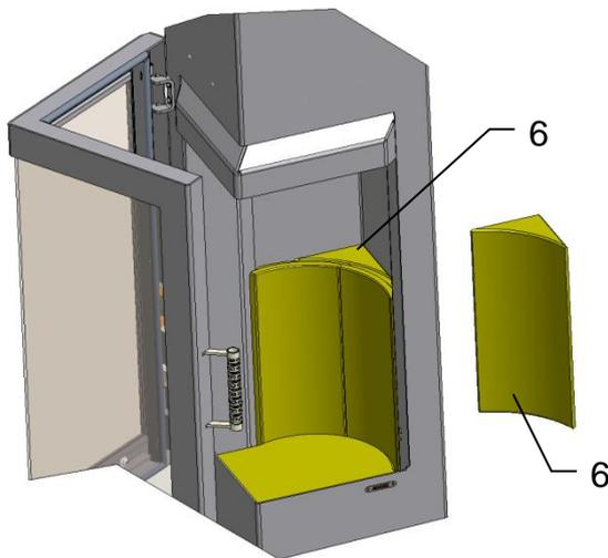
Den zweiten Eckstein (6) auf den bereits eingebauten Eckstein (6) setzen.
