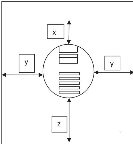
Neben den reinen Sicherheitsmindestabständen muss die Möglichkeit gegeben sein, dass normale Reinigungs- bzw. Wartungsarbeiten ausgeführt werden können. Es sind daher folgende Mindestabstände für Wartungs- und Reinigungsarbeiten einzuhalten:
