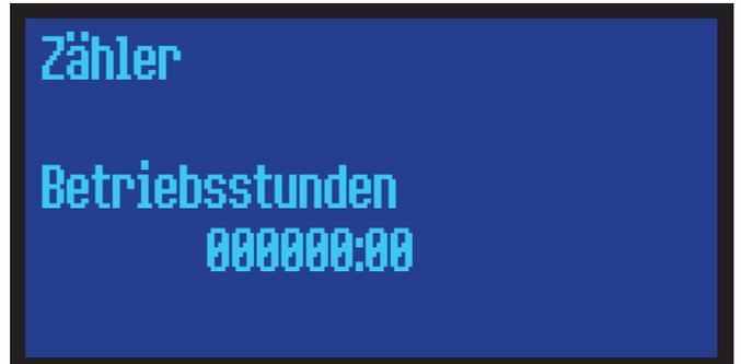
Anzeige der Betriebsstunden im Format Stunden:Minuten.
