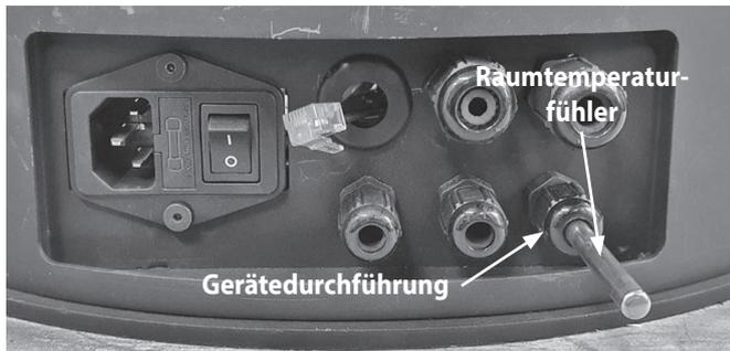
Für realistische Messwerte ist der **Raumtemperaturfühler (16)** zumindest soweit aus der Gerätedurchführung zu ziehen, bis der komplette **Raumtemperaturfühler (16)** sichtbar wird (A).
