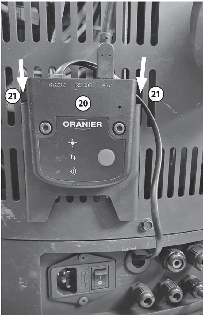
► Schieben Sie das Anschlusskabel so weit wie möglich zurück in das Gerät.
