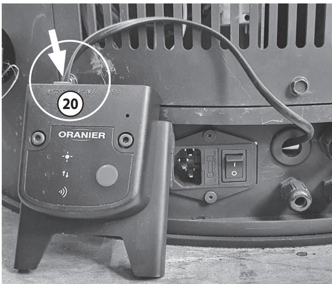
Schließen Sie die Stromversorgung an das **Wi-Fi-Modul (20)** an.
