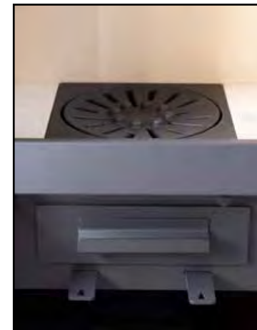
Brennkammer, Aschekasten, Luftschieber
