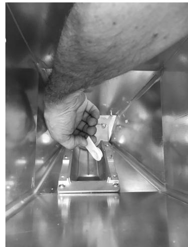
**Fig. 66 - Lager entfernen**
