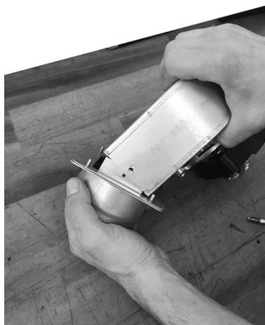
**Fig. 31 - Den Flansch + Fitting am Ventilator fixieren.**
