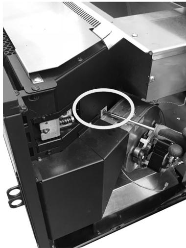
*Fig. 68 - Die Schraube 1 entfernen.*
