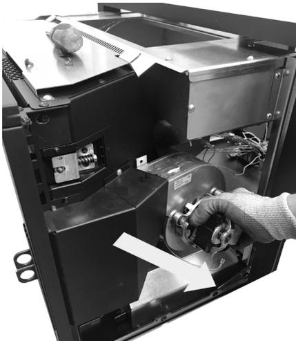
*Fig. 70 - Den Ventilator entfernen*
