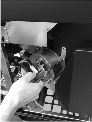
**Fig. 28 - Die Schrauben entfernen.**
