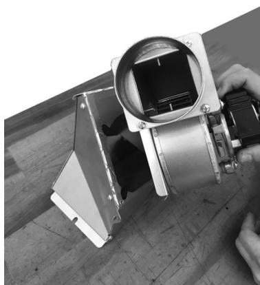
**Fig. 34 - Den Ventilator am Gehäuse fixieren.**
