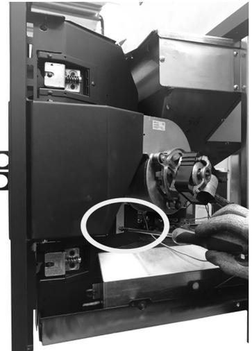
*Fig. 69 - Die Schraube 2 entfernen.*
