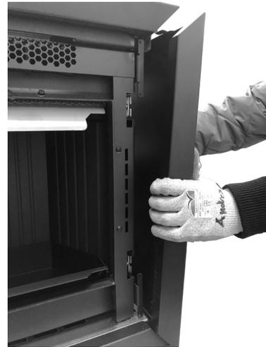
**Fig. 19 - Die Seitenwand aushängen.**
