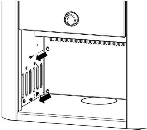
Abb. 39: Sockelblende demontieren
