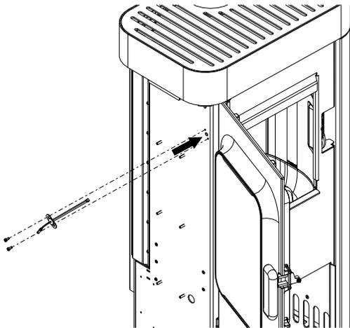
Abb. 28: Feuerraumtemperaturfühler befestigen
