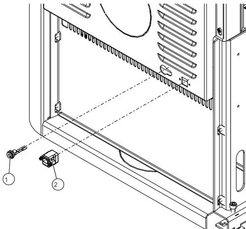
Abb. 29: Gleichstrombuchse u. Netzwerkbuchse montieren
