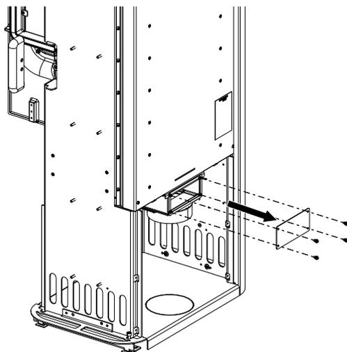
Abb. 21: hinteren Deckel demontieren
