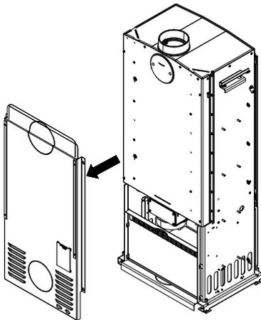
Abb. 14: Rückwand demontieren
