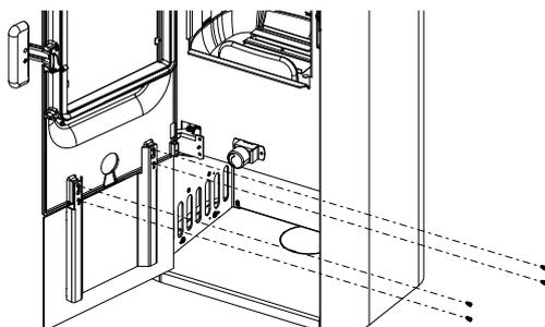
Abb. 38: Sockeltür montieren
