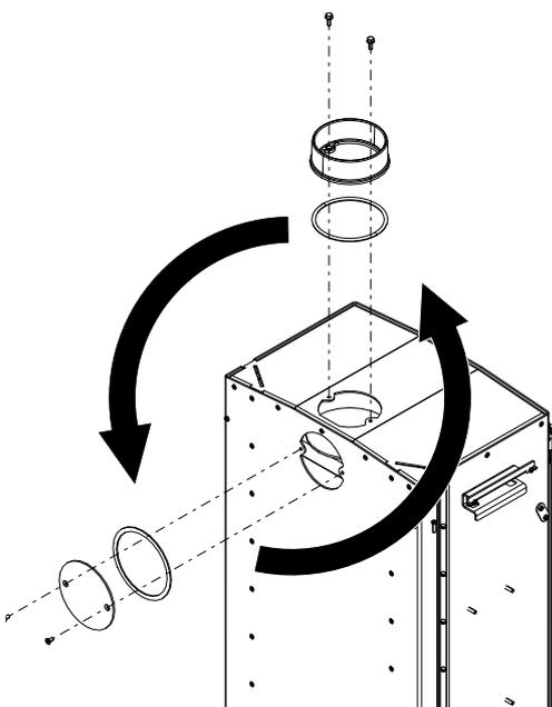
Abb. 16: Abdeckung und Stützen tauschen
