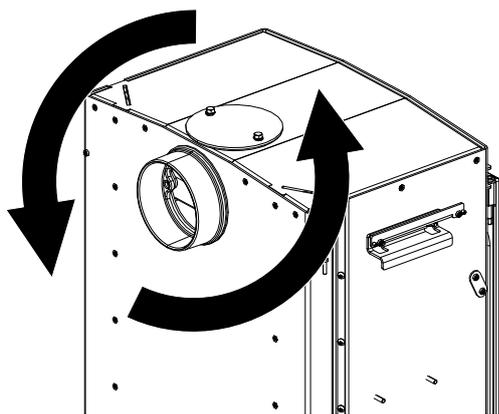
Abb. 17: Abdeckung und Stützen getauscht
