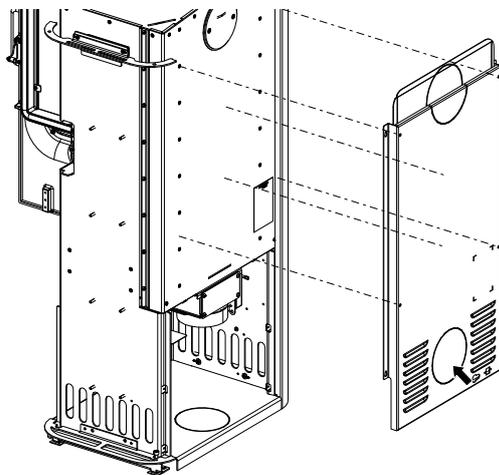
Abb. 20: Rückwand demontieren und den perforierten Ausschnitt entfernen
