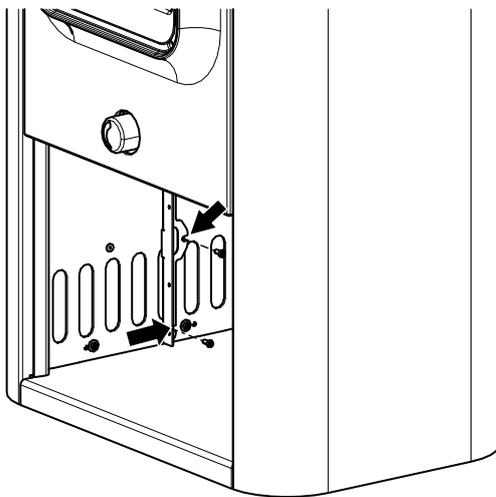
Abb. 40: Sockelblendehalterung montieren
