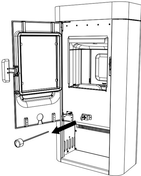
Abb. 25: Drehglereinheit ausbauen
