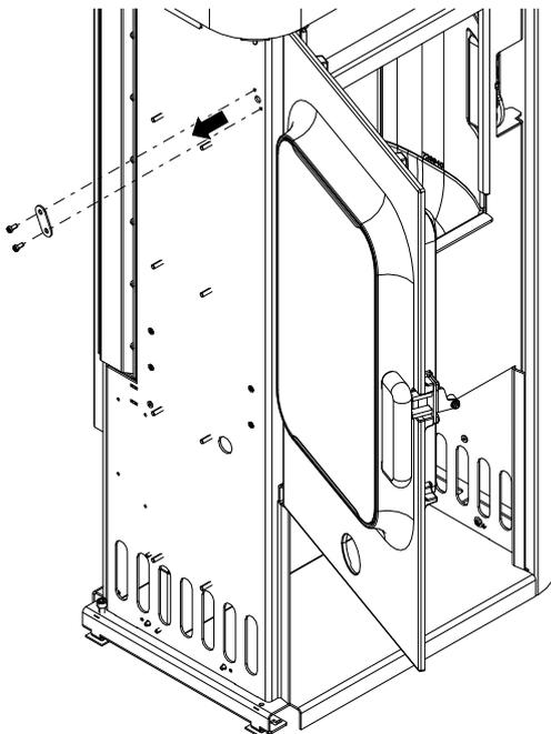
Abb. 26: Abdeckplatte entfernen
