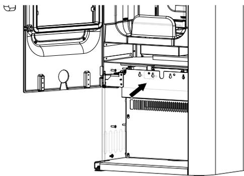
Abb. 30: Abdeckung montieren
