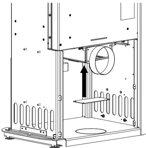
Abb. 24: Luftanschluss hinten
