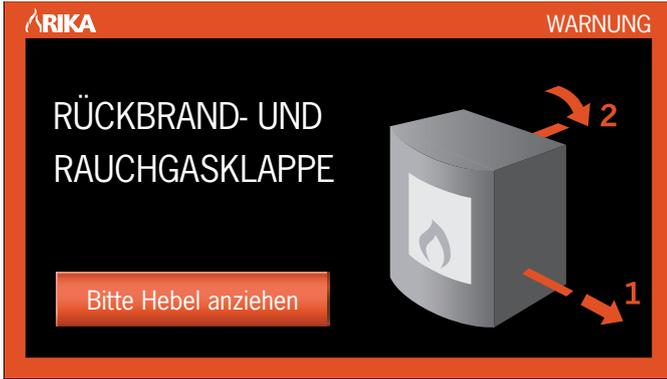
Für den Betrieb muss die Rückbrandklappe geöffnet und die Rauchgasklappe geschlossen werden.
