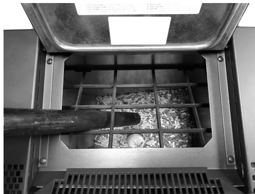
Fig. 26 - Reinigung Tank und Schnecke
