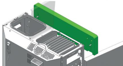
Für den rechten Stein entfernen Sie die selbstsichernde Sechskantmutter inkl. Abdeckplatte im Pelletbehälter.
