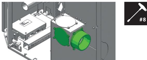
Setzen Sie das entsprechende Rauchrohr auf den Rauchgasstutzen auf. Achten Sie auf eine dichte Ausführung!
