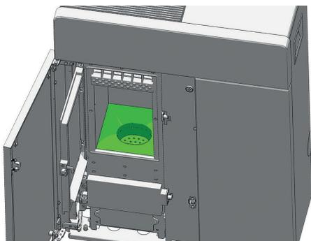
Achten Sie bei der Reinigung mit der Bürste darauf, dass Sie die Zündung nicht beschädigen. Saugen Sie das Zündrohr mit dem Staubsauger aus.
