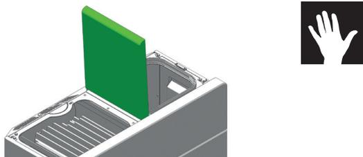
Entfernen Sie nun die 2 Flügelschrauben an der oberen Kante der Seitenwand und heben Sie sie nach oben ab.
