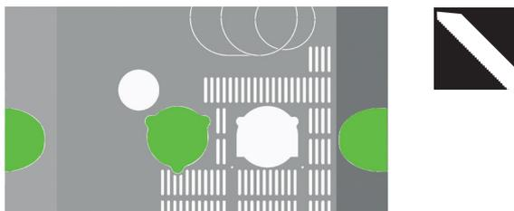
Für die **Anschlüsse seitlich** schneiden Sie die entsprechende Seitenverkleidung des Ofens entlang der markierten Perforierung aus.
