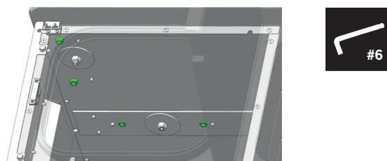
Achten Sie vor dem Aufsetzen des Konvektionsdeckels darauf, dass die 4 Gewindestifte bündig abschließen.
