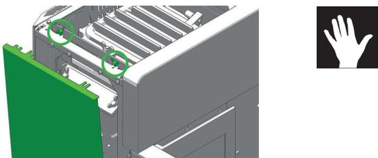
Entfernen Sie die selbstsichernde Sechskantmutter inkl. Abdeckplatte, die zur Abdichtung des Pelletbehälters dient, und die Sechskantmutter inkl. Beilagscheibe auf der anderen Seite.
