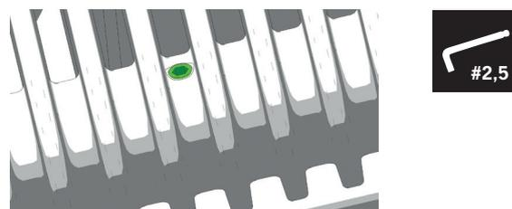
Den Konvektionsdeckel danach vorsichtig in die dafür vorgesehenen Ausnehmungen setzen und mit der Hand nach unten drücken, bis der Deckel einrastet.
