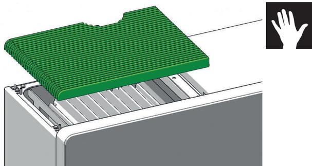
Öffnen Sie den Pelletbehälterdeckel vorsichtig bis zum Anschlag, in dieser Position bleibt er geöffnet.
