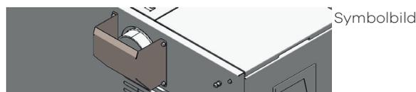
Ein Betrieb ohne Abdeckung oder ohne angeschlossene Konvektionsleitungen ist nicht erlaubt. Missachtung führt zu Garantieverlust und für Schäden wird keine Haftung übernommen.
