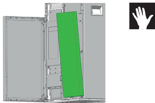
Montieren Sie die abgebauten Teile wieder in umgekehrter Reihenfolge.
