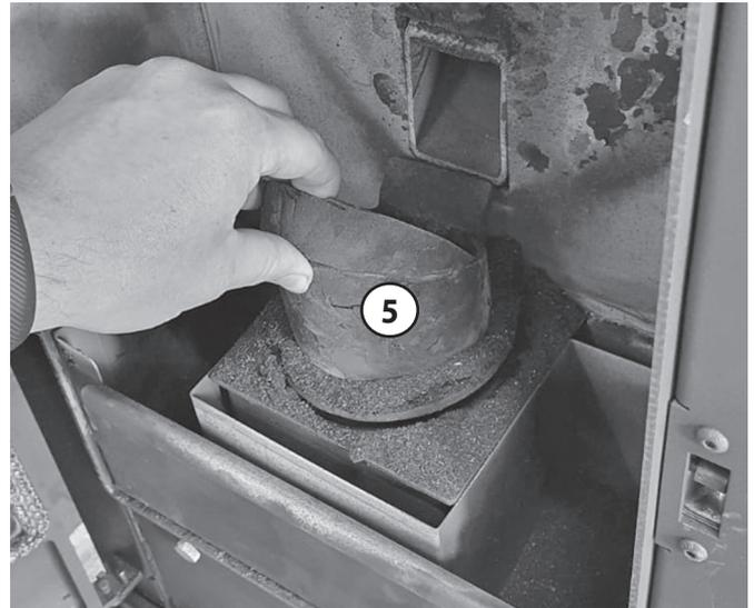
Nach einer gründlichen Reinigung dürfen sich keine Aschenreste mehr in der Brennerschale befinden. Auch festgebrannte Überreste sind bestmöglich zu entfernen und alle Bohrungen in der Brennerschale müssen offen sein.
