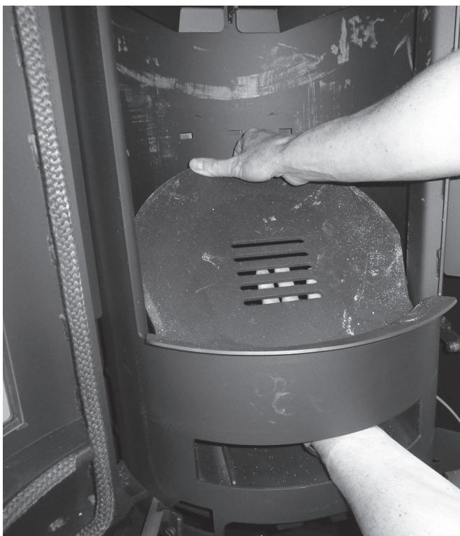
Über den Vermiculite-Rauchgasumlenkungen befindet sich eine zweite Rauchgasumlenkung aus Blech.
