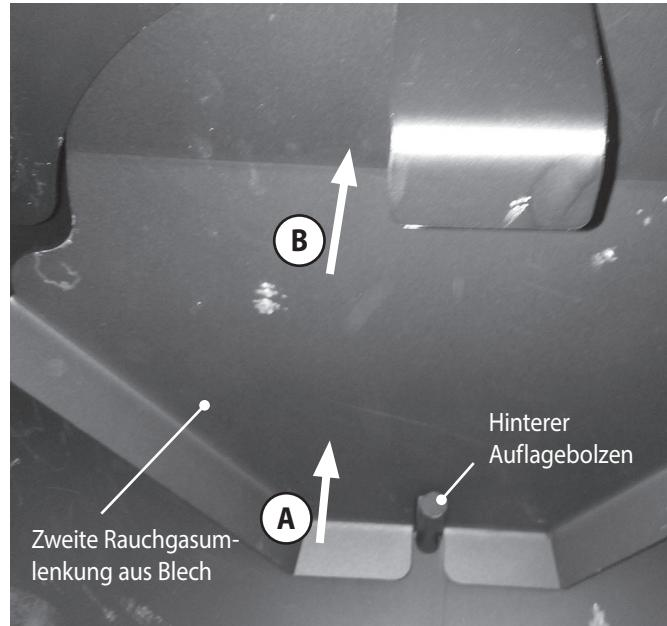
Über der zweiten Rauchgasumlenkung aus Blech sitzt eine dritte Rauchgasumlenkung aus Blech.
