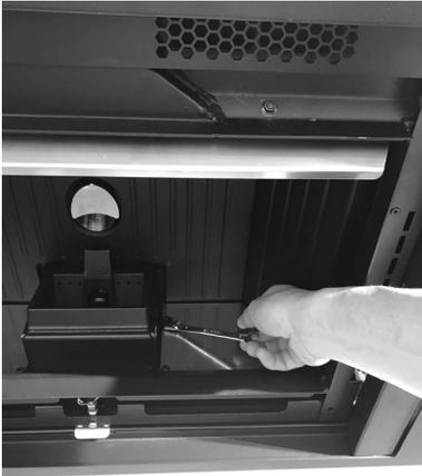
**Fig. 31 - Entfernung der kleinen Böden**
