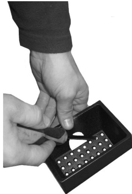
**Fig. 27 - Reinigung Brennschale**
