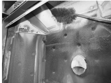
**Fig. 35 - Reinigung mit Flaschenbürste**
