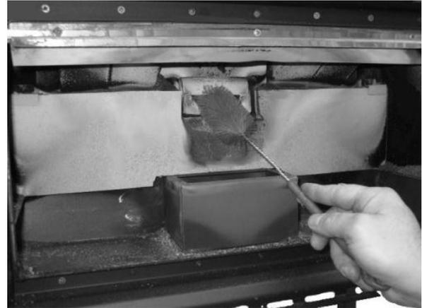
**Fig. 29 - Reinigung mit Flaschenbürste**
