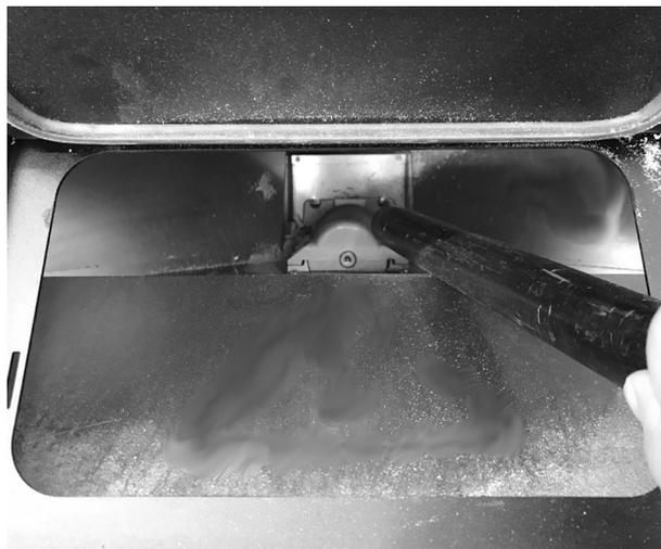
**Fig. 30 - Reinigung Tank und Schnecke**
