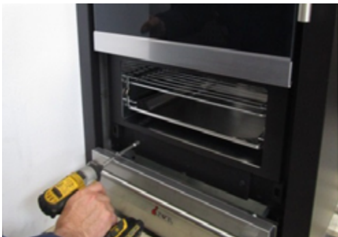
Fig. 18 - Die Schrauben entfernen
