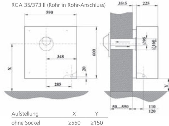
Beim Auswechseln älterer Gasraumheizer (RGA 50/411, 431, 441) durch neue Gasheizautomaten kann in den meisten Fällen die konzentrische Einrohrwanddurchführung unverändert genutzt werden.
