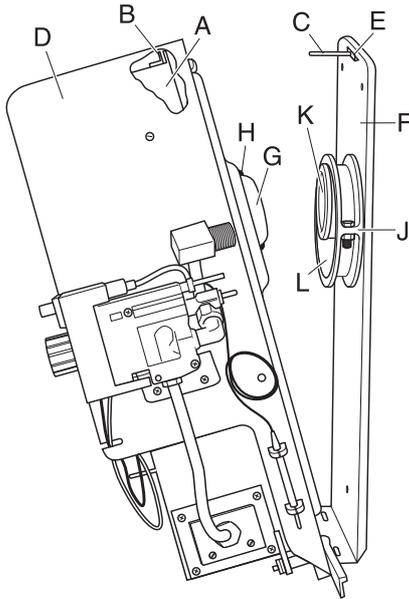
**⚠ Achtung:** Die Schnittkante des Frischluftrohres, die gleichzeitig Dichtkante ist, muss am Ende des Flansches abschließen oder darf nur geringfügig zurückstehen.
