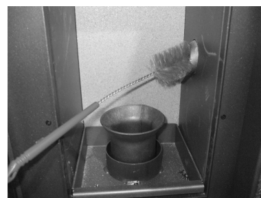
Fig. 28 - Reinigung mit Flaschenbürste
