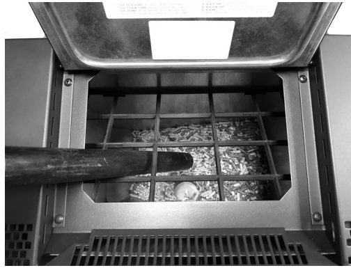
Fig. 29 - Reinigung Tank und Schnecke
