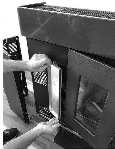
Fig. 31 - Die Inspektionsplatte entfernen
