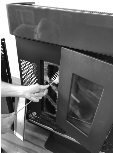
Fig. 32 - Reinigung mit Flaschenbürste
