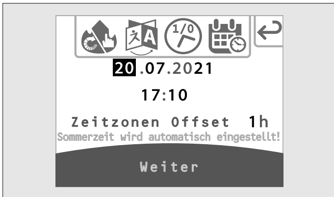
Abb. 3.27 Touch-Bedienfeld – Einstellen Datum und Uhrzeit
