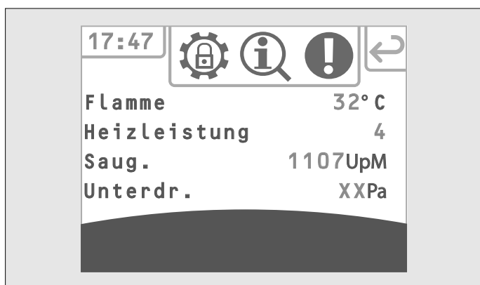
Abb. 3.31 Touch-Bedienfeld – Anzeige „Aktuelle Informationen“
