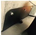
**7:** Placez la pierre contre la plaque métallique afin que ses trous se trouvent en face des trous de la pierre. Fixez ensuite la pierre avec les boulons fournis à l'aide d'une clé (à cliquets) 10mm.
