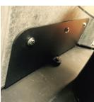
**7:** Der Stein muss gegen die Metallplatte platziert werden, damit alle Gewindelöcher in die vorbereiteten Löcher passen. Danach mit einem 10er Schraubenschlüssel festziehen.
