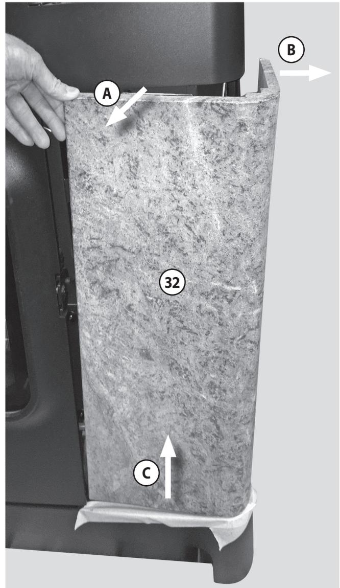
Hinter der abgenommenen **Eckverkleidung (32)** wird der **Abgasventilator (28)** zugänglich.
