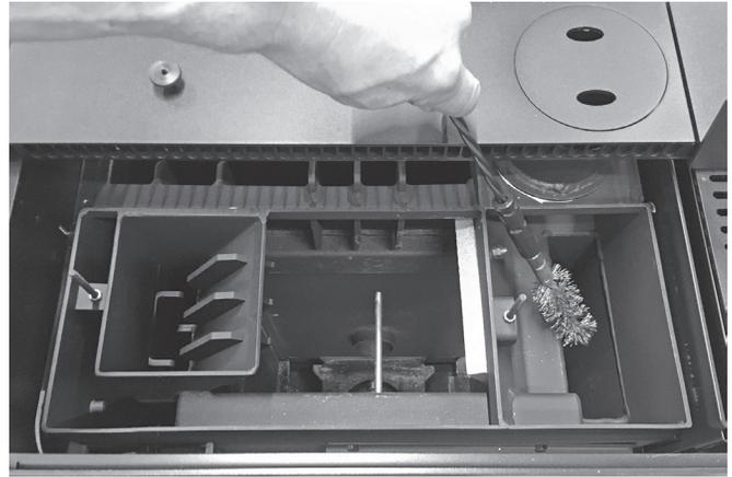
**i** Für eine vollständige Reinigung ist die rechte Seitenverkleidung zu demontieren und der **Rauchwegdeckel (11)** zu entfernen (→ Kapitel 12.4).
