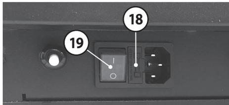
Im Bereich des **Netzschalters (19)** befindet sich auch die **Geräte-Hauptsicherung (18)**.
