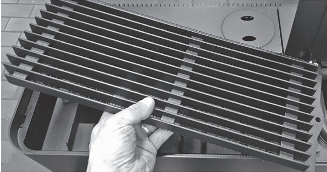
Der Brennraumdeckel bildet den Abschluss des Brennraums nach oben. Er muss demontiert werden, um die Reinigung der Heizgaszüge zu ermöglichen.
