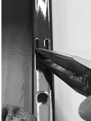
Fig. 45 - Biegen der kleinen Zungen nach außen
