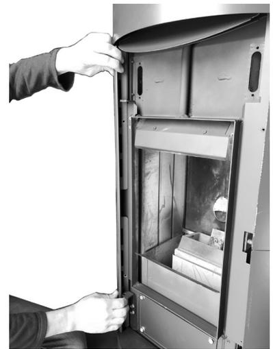
*Fig. 65 - Frontprofile (rechts und links) entfernen.*
