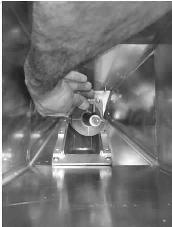
**Fig. 80 - Spirale entfernen**
