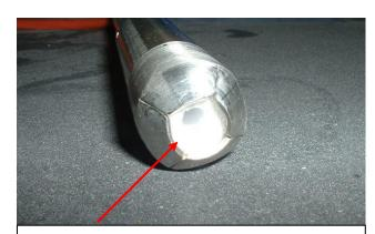
Styroporkappe als Transportsicherung, verbrennt bei Erstzündung
