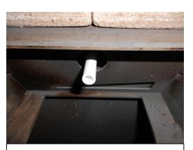
Zündung ist gesteckt und kann herausgezogen werden bzw analog wieder montiert werden
