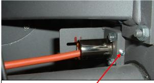
10. Zündrohr mindestens 3 bis max. 5 mm zurückziehen und mit Schraube fixieren (siehe Markierung).
