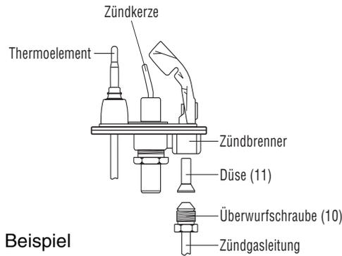
Eine Dichtung zwischen Zündbrenner und Heizkörper gewährleistet die Abgasdichtheit.
