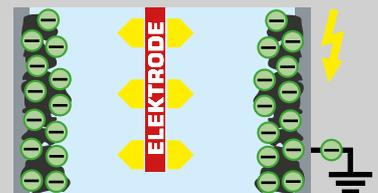
**04** Der Feinstaub sammelt sich an der Kaminwand an und verklumpt zu groben Flocken. Diese Ablagerungen werden bei der Reinigung durch den Kaminfeger entfernt.
