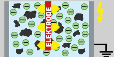
**02** Durch eine Hochspannungselektrode werden Elektronen freigesetzt.
