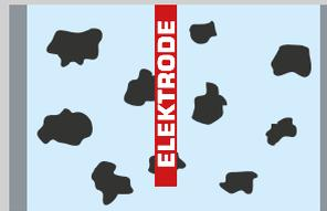
**01** Feinstaubpartikel strömen mit der Abluft durch den Abgaskanal.
